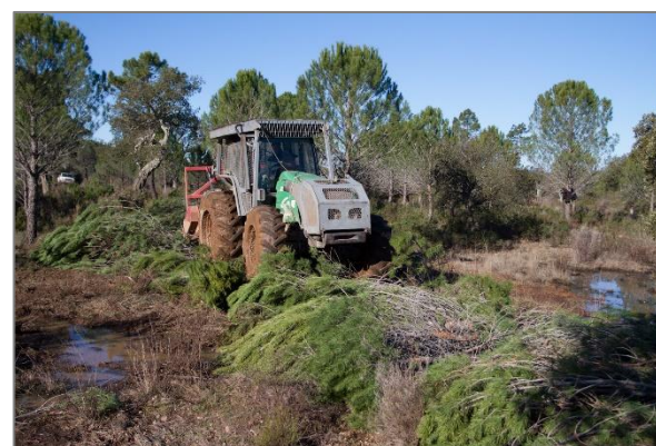
Evacuation des bois par porteur et utilisation de rémanents pour réduire l'impact au sol du passage d'engins lourds © J. CELSE
