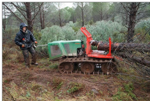
Skidder avec câble et Forest Horse (chenillard) utilisés pour le débardage © J. CELSE
