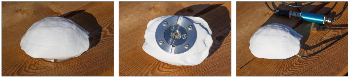
Modèles en PEHD réutilisables disponibles prochainement et capteur de pression permettant de mesurer la pression exercée sur une carapace © J. CELSE
