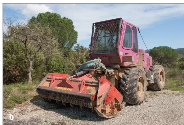
Débroussaillage manuel (a) et tracteur forestier équipé d'un gyrobroyeur (b) © J. CELSE
