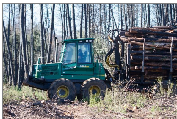
Evacuation des bois par porteur et utilisation de rémanents pour réduire l'impact au sol du passage d'engins lourds © J. CELSE
