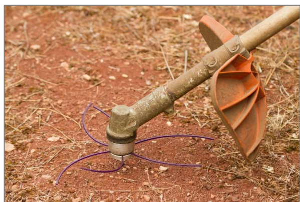
La lame broyeuse (photo de gauche) ne peut être utilisée qu'en hiver, en dehors de cette période utiliser le fil (photo de droite) © J. CELSE
