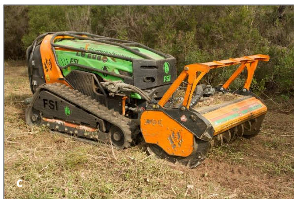
Gyrobroyeurs radiocommandés, Green Climber LV600 de FSI/MDB (c) et RoboMIDI d'ENERGREEN (b) © J. CELSE
