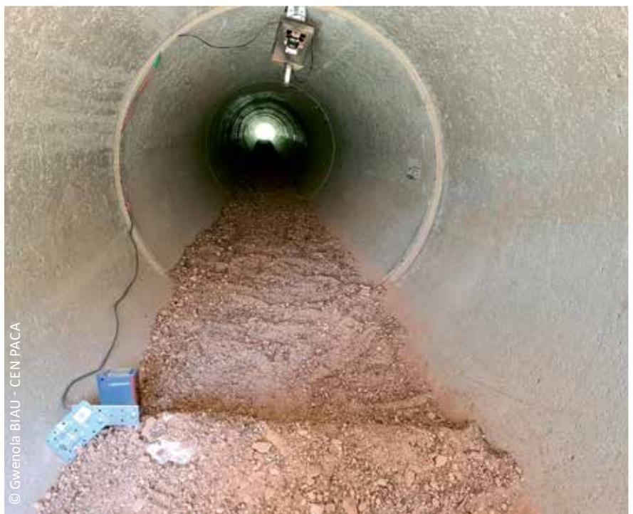
Dispositif de suivi d'un écoduc avec appareil photographique et barrière infrarouge
