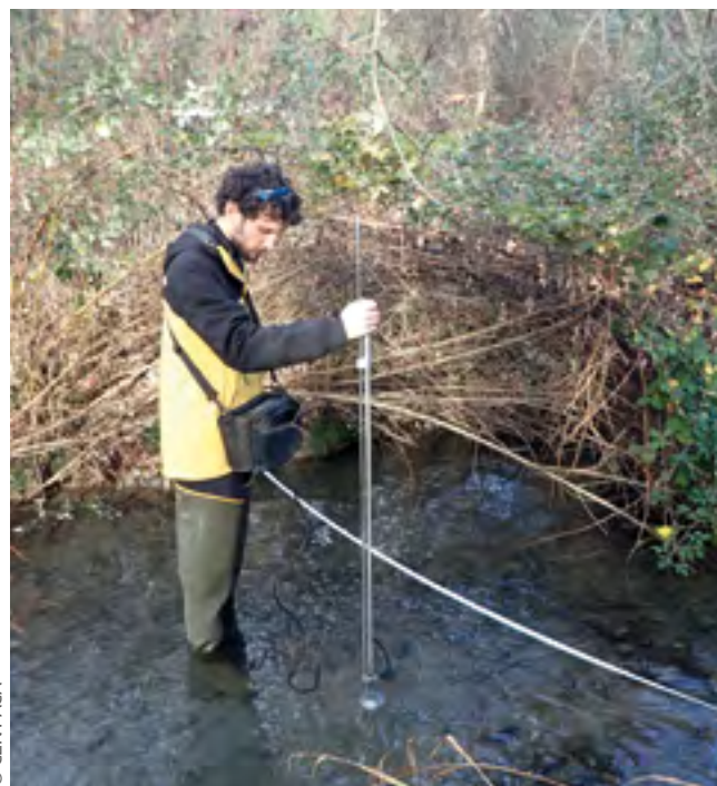
Relevé des débits dans l'Adous des Faïsses, Mallemoison (04)
